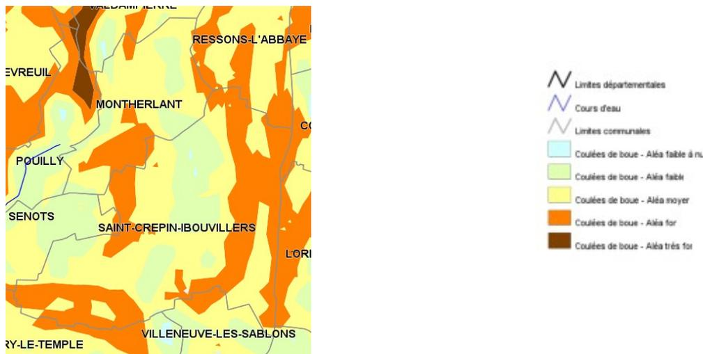
La coulée de boue est un mouvement rapide d'une masse de matériaux remaniés, à forte teneur en eau et de consistance plus ou moins visqueuse. Elle prend fréquemment naissance dans la partie aval d'un glissement de terrain ou dans les terrains mis à nu par les activités humaines. Les matériaux susceptibles de perdre ainsi leur cohésion sont des argiles, des limons, des sols, des roches décomposées ou des éboulis fins (source : Géorisques).
